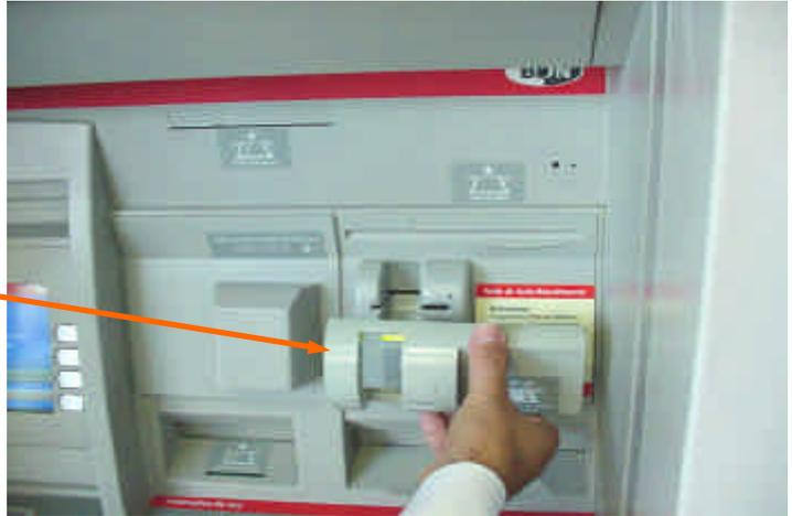
2- El dispositivo instalado en el Cajero.
