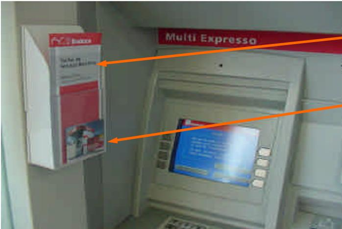
Dispositivo para grabación simulando un porta panfletos, instalado en el carenado del cajero.
